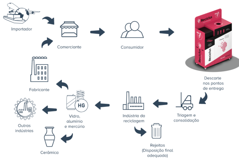
Figura 5 – Logística reversa de lâmpadas fluorescentes, de vapor de sódio e mercúrio e de luz mista
