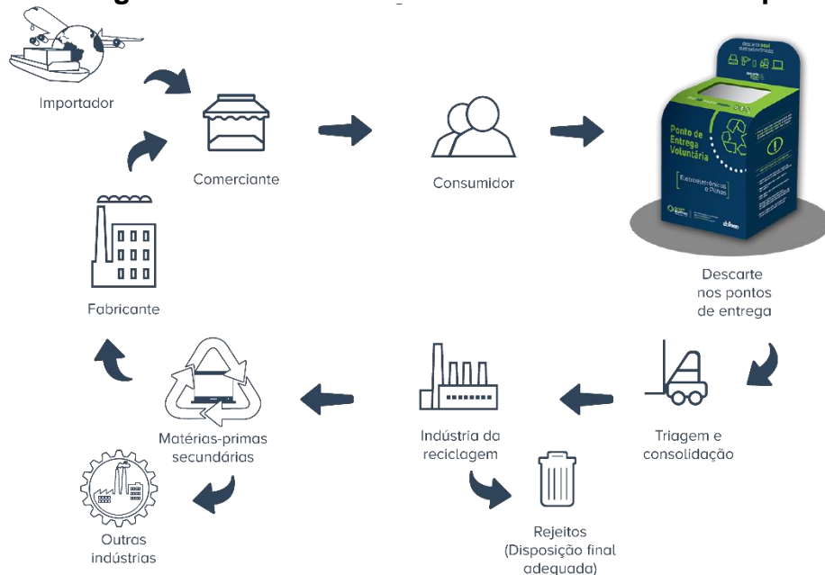
Figura 6 – Logística reversa de eletroeletrônicos e seus componentes
