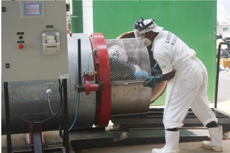
Figura 19 – Operação da Autoclave para tratamento de RSS
