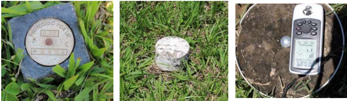
(a) Marco localizado próximo da ponte Cinquenta e Oito (b) Estação de coleta de dados Rio Macabuzinho (marco1) (c) Estação de coleta de dados Rio Macabuzinho (marco 2) Figura 3.3 – Marcos utilizados para validação dos dados de GPS (Maia, 2021)
