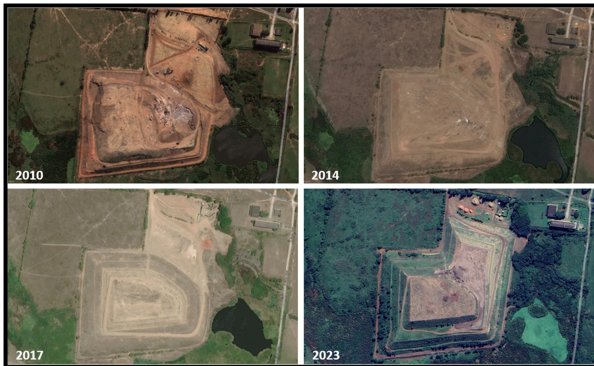
Figura 8 – Antigo Vazadouro remediado (atual aterro de inertes)
